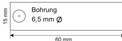
Leiste zuerst bohren, dann absägen. (Die Bohrung ist sehr nah am Rand und bricht dadurch leicht aus.)
