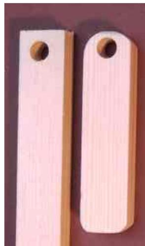
Die Bohrung für die Klapperleisten ist sehr nah am Ende der Leiste und bricht deswegen sehr leicht aus.
